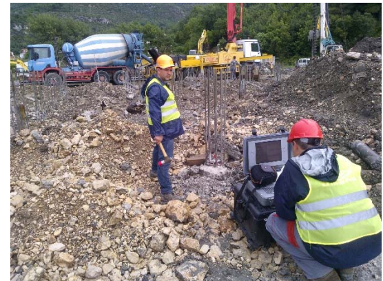
Ispitivanje integriteta izvedenog pilota
