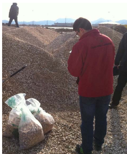
← Uzimanje uzoraka materijala za kontrolna ispitivanja
