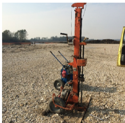
Sondiranje nakon konsolidacije tla
