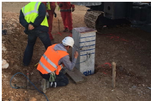
Einbau der Sensoren für den Test
