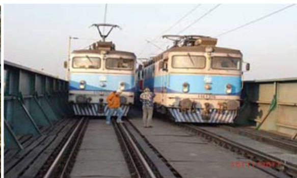
← Maximale Probelastung der mittleren Spannweite
